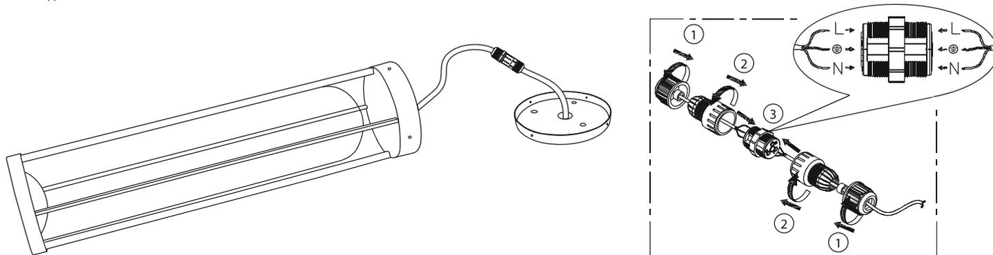
4. Закрепите светильник на монтажной чаше
