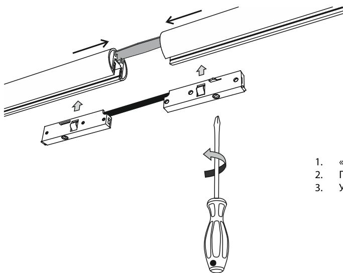
1. «Соединительной планкой» скрепите два отрезка шинопровода
