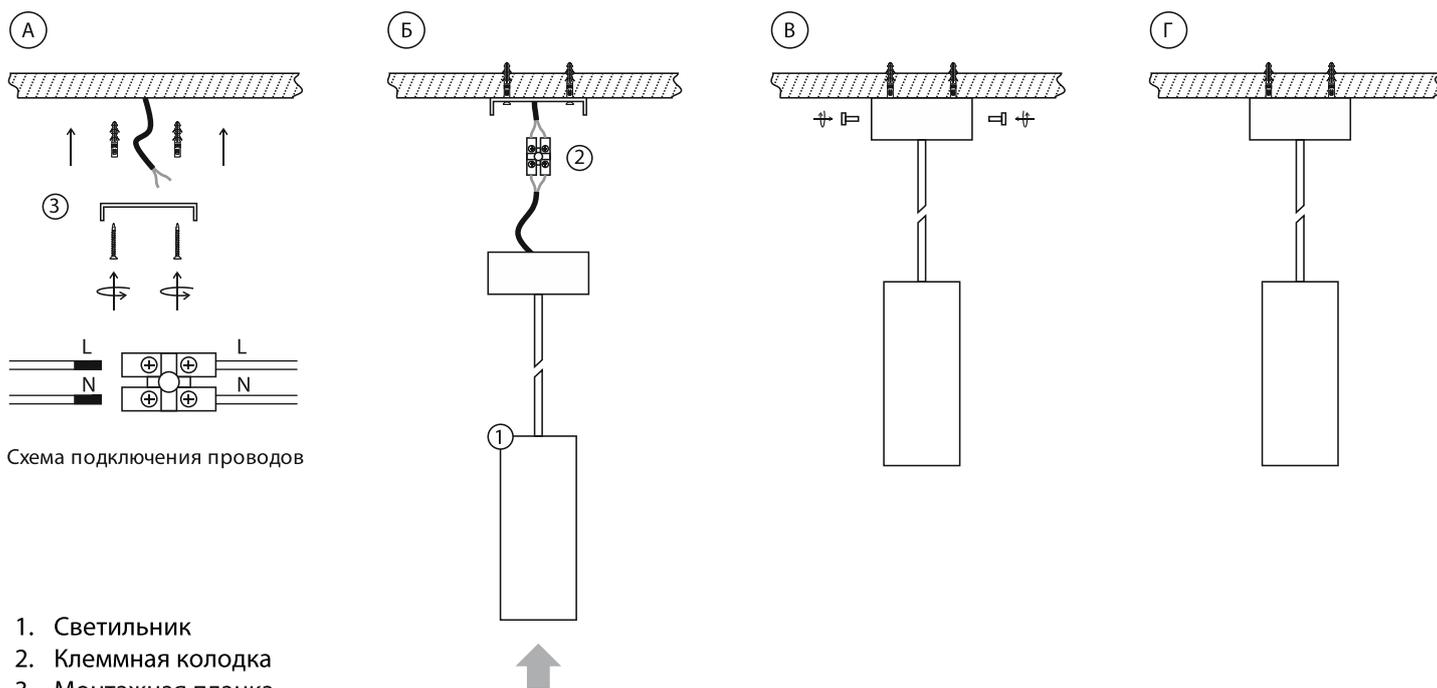
Схема подключения проводов
