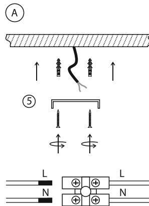
Схема подключения проводов
