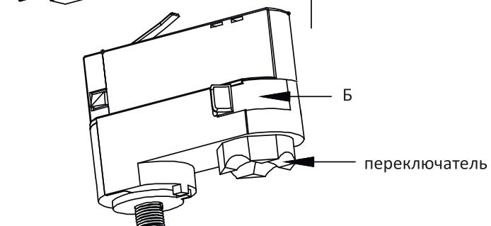
Установите светильник в шинопровод, поверните фиксатор в положение Б. Поворотом переключателя подключите светильник.
