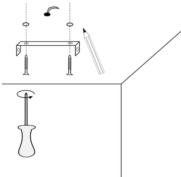
Разметьте место монтажа и закрепите монтажную скобу
