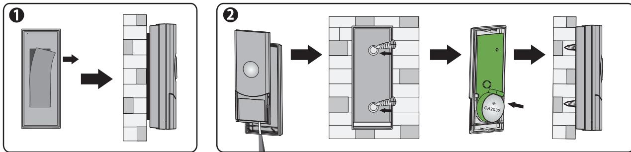
Для монтажа на саморезы необходимо снять заднюю крышку передатчика, зафиксировать ее на стене и затем установить основание передатчика в крышку.
