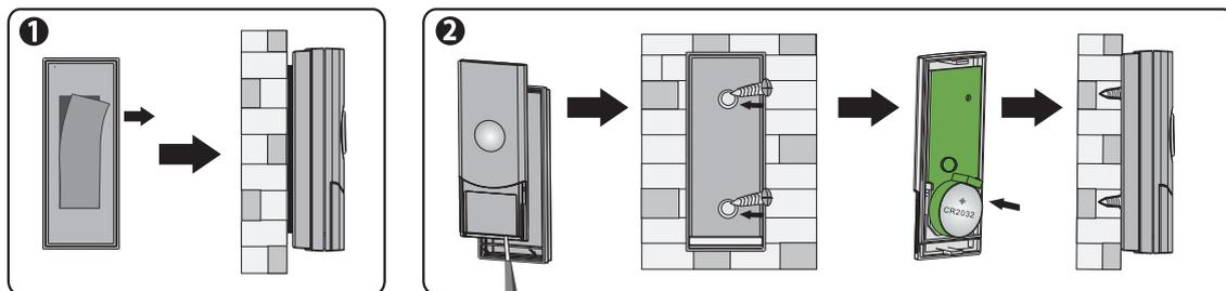
Для монтажа на саморезы необходимо снять заднюю крышку передатчика, зафиксировать ее на стене и затем установить основание передатчика в крышку.
