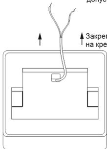
↑ Закрепить светильник на крепежной планке
