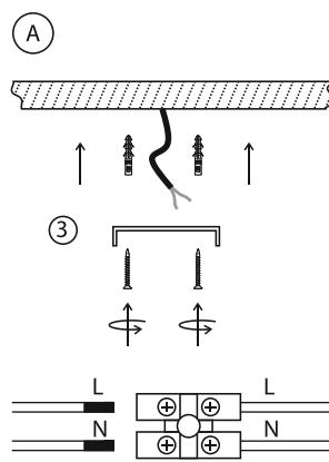
Схема подключения проводов
