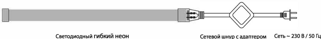
При сборке нанесенные на гибкий неон стрелки должны быть направлены от сетевого адаптера к концу гибкого неона. Для надежной фиксации и герметизации соединений перед установкой обработайте коннекторы, заглушки и сетевой шнур клеем-герметиком для ПВХ. Для обеспечения пылевлагозащиты и во избежание удара током на свободный край ленты обязательно следует установить заглушку. Перед включением в сеть убедитесь в правильном подключении контактов.
